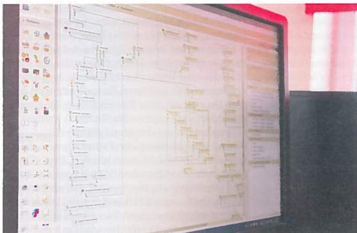
Im Workflow-Manager lassen sich Arbeitsabläufe per Drag & Drop erstellen und Jobs in Echtzeit verfolgen. MIS-, Shop- und Finishingsysteme sind anbindbar.
